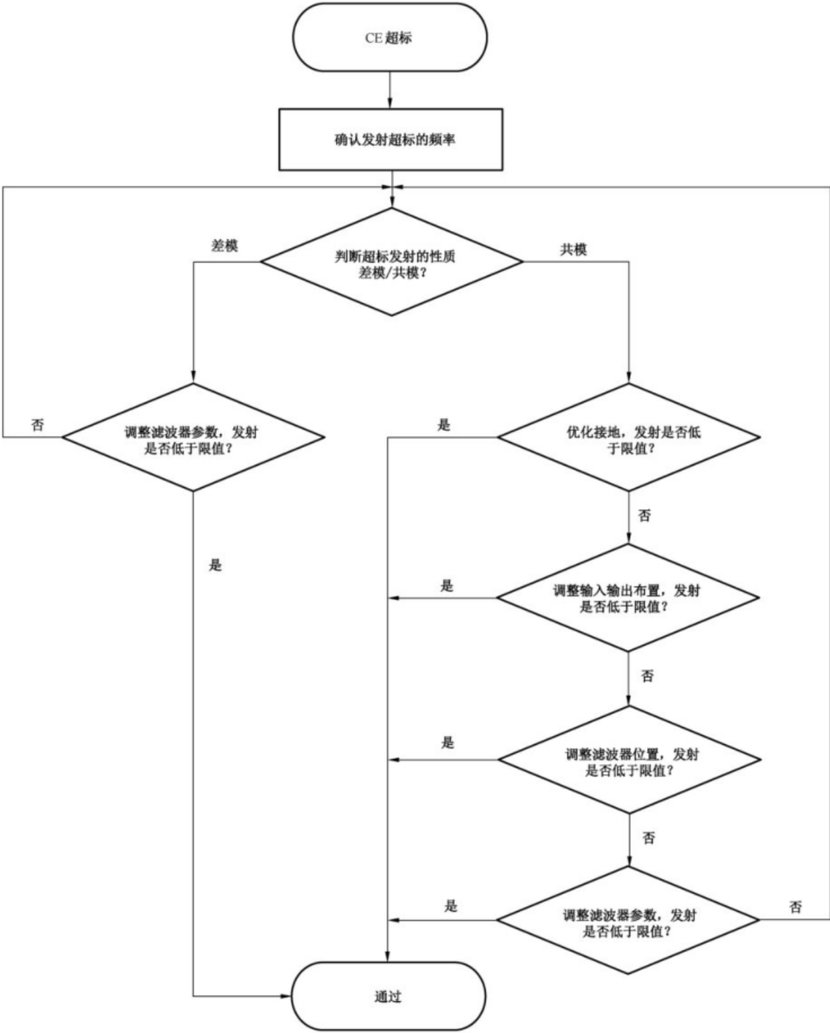
图 12 在实验室进行 CE 诊断的流程图示例
