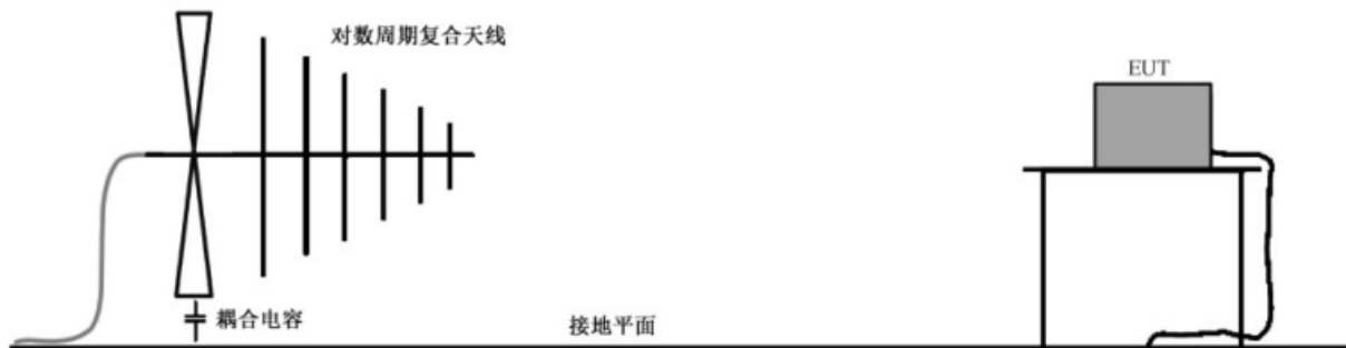
图 10 对数周期复合天线与接地平面之间的容性耦合(大约 100 MHz 以下)
