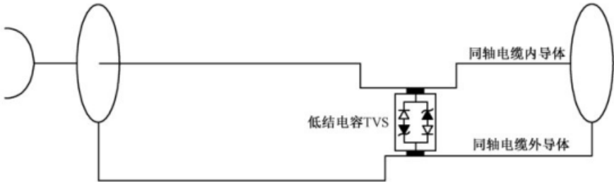
图 C.6 天线端口单级浪涌防护电路示例
