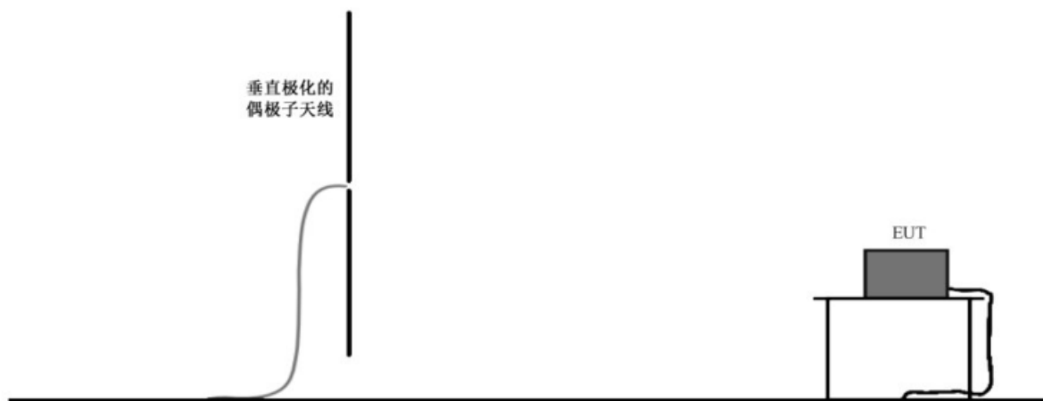
图 11 在较低频率时使用垂直极化的偶极子天线测量 RE
